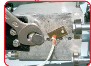
abaixar a temperatura para 140°C e Colocar 1 Litro de limpador do coleiro Afix 140 , deixar em repouso por aproximadamente 2 horas retirar o parafuso de esgotamento e esperar escorrer todo produto, colocar o parafuso e repor a cola.
