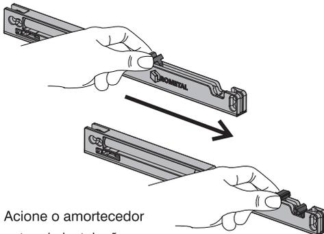
Acione o amortecedor antes da instalação.
