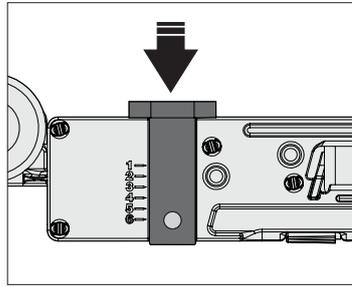
O amortecedor possui um ajuste de posicionamento para regulagem em diferentes tipos de porta
