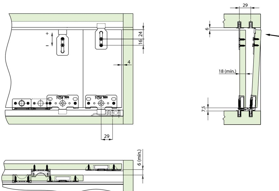
Usinagem das canaletas inferior e superior com utilização do perfil
