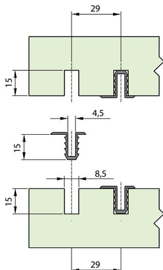
Montagem do perfil na canaleta e instalação do batente trava
