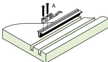
Usinagem para instalação do deslizador inferior da porta
