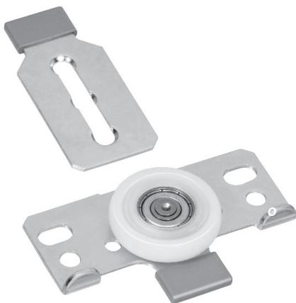
**Descrição:** Rodízio para porta de correr apoiada, composto por deslizador inferior com rolamento 626 blindado, guia superior, limitador de curso da porta e batente trava em plástico. Pode ser montado com perfis de plástico ou alumínio.
